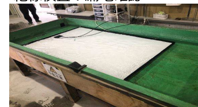
絶縁検査：漏電確認
